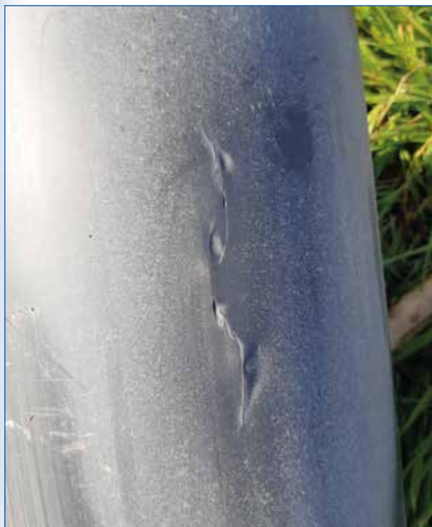
Figura 2. Rotura en estado inicial por fatiga en un tubo de PVC200-16 (la presión habitual es de 11 bar, pero la red está oscilando entre 10 y 13 bar de 2 a 4 veces por minuto) (izquierda), y tornillos degradados en un entorno salino y que han provocado una fuga en la brida donde estaban instalados (derecha).
