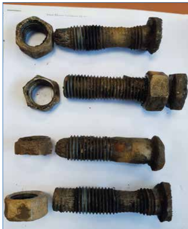
Figura 2. Rotura en estado inicial por fatiga en un tubo de PVC200-16 (la presión habitual es de 11 bar, pero la red está oscilando entre 10 y 13 bar de 2 a 4 veces por minuto) (izquierda), y tornillos degradados en un entorno salino y que han provocado una fuga en la brida donde estaban instalados (derecha).
