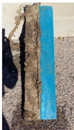
Figura 55. Placa con tratamiento antifouling donde no se adhieren los briozoos. Fuente: C.R. Valle Inferior del Guadalquivir.
