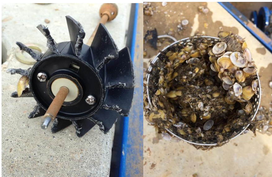
Figura 39. Izquierda: Daños en hélice de contador tipo Woltman. Derecha: Obstrucción de filtro cazapiedras por acumulación de almeja asiática y briozoos. Fuente. C.R. Valle Inferior del Guadalquivir.
