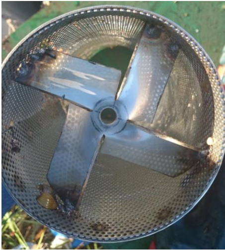
Figura 61. Interior del filtro cazapiedras STF. Fuente: C.R. Valle Inferior del Guadalquivir.
