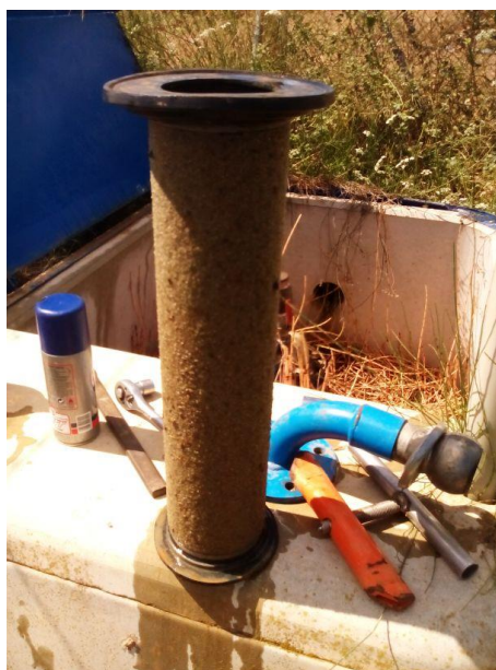
Figura 6. Colmatación por briozoos en un filtro de mallas. Fuente propia.
