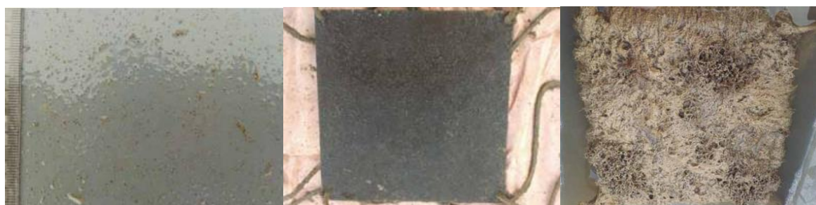
Figura 44. Izquierda: Estatoblastos germinando en las placas de PVC. Central: Inicio del crecimiento de la colonización. Derecha: Crecimiento máximo de las colonias. Fuente: Toscano Línea Electrónica SL.
