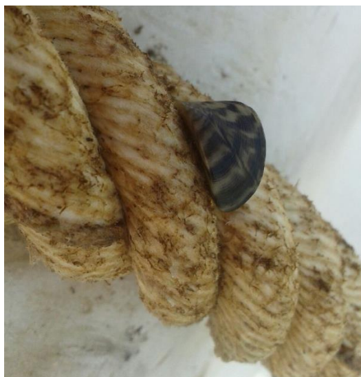
Figura 46. Control de la evolución del mejillón cebra mediante sogas en las balsas de la Comunidad de Regantes del Valle Inferior del Guadalquivir. Fuente propia.
