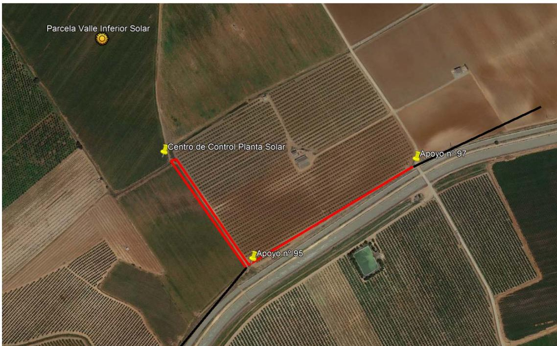
Podría emplearse el tendido actualmente existente entre los apoyos nº 95 y nº 97 para derivarlo hacia la planta solar, siempre que su longitud y forma de recuperación así lo permitan; de tal modo que, en este caso, el nuevo tendido de fibra habría de extenderse desde la planta solar hasta la caja de conexión del apoyo nº 97, pasando previamente por los apoyos nº 95 y nº 96.
